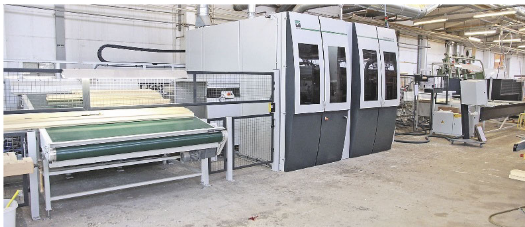
/ Moderne Fertigung: Auf der Weinig Conturex C 124, die Hermann-Blösch vor drei Jahren gekauft hat, werden Schiebetüren und Schwingfenster CNC-gesteuert gefertigt.
